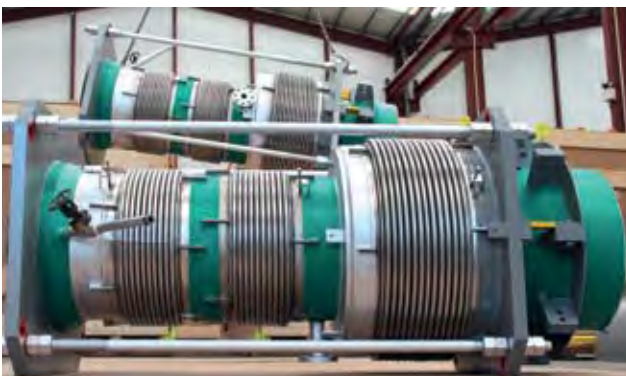
Реактор установки флексикрекинга Линейный уравновешенный по давлению компенсатор Двухслойные контролируемые сильфоны Расчетная температура: 566 °С (среда)
